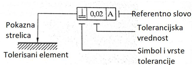
Pokazna strelica se postavlja na tolerisani element. Okvir može biti podeljen dva ili tri polja, u prvo polje okvira upisuje se simbol vrste tolerancije. U drugi deo polja upisuje se tolerancijska vrednost. Referentno slovo upisuje se u treće polje okvira. Znak za pokazni element sastoji se od okvira i referentnog trougla spojenih linijom. U okvir se upisuje referentno slovo, referenti trougao se postavlja na polazni element.
