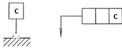
Referentna površina je površina A i upisuje se u treće polje, dok je simbol za upravnost  $\perp$  koje se unosi u prvo polje, dok se u drugo unosi vrednost tolerancije 0.1, na slici je dat prikaz tolerancije oblika i položaja.
